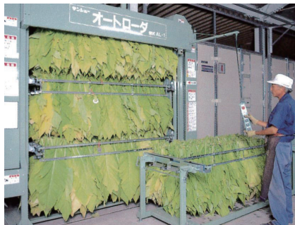
図-11 黄色種機械乾燥室（乾燥前）
