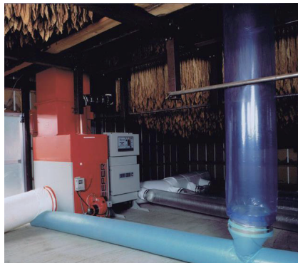
図-10 パーレー種温湿度コントロール装置
