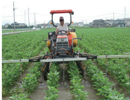
図-8 乗用管理機での大豆畦間・株間への除草剤散布状況
