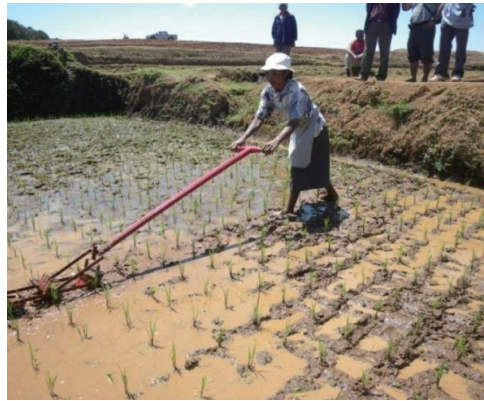
図-9 水田除草機と農家圃場における適用性試験状況
