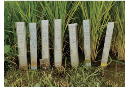
図-4 OPP袋と印刷文字の耐久性・耐候性の確認
