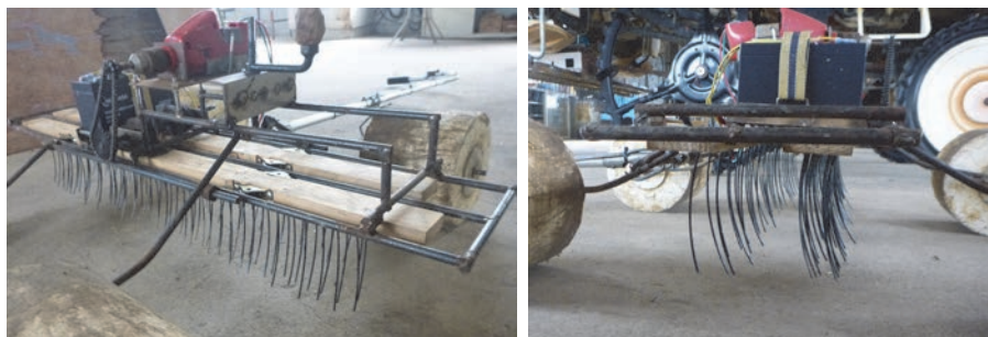
図-2 揺動ブラシ式除草機構（2017年試作機）
