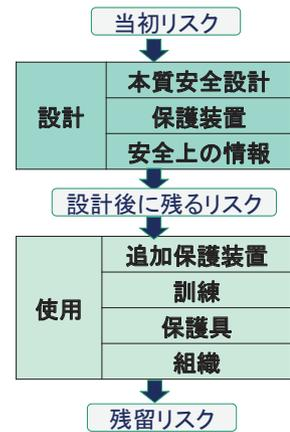
図-2 リスク低減策 (Three Step Method)
