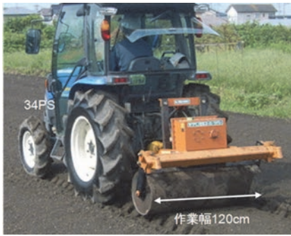
図-2 振動鎮圧作業【型式：SV2-T(川辺農研産業(株))】
