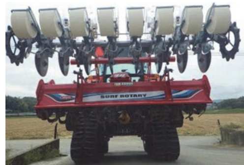
図-6 一発耕起播種機【型式：KTBM2200E-C((株)クボタ)】
