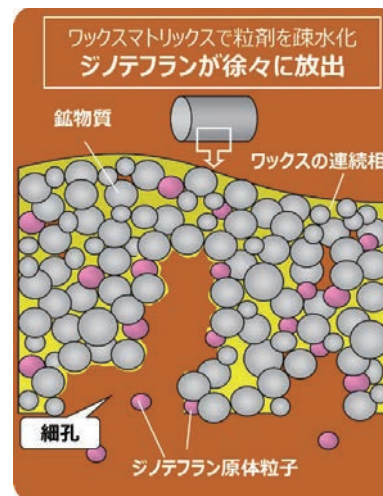
図-11 ワックスマトリックスで放出制御の仕組み
