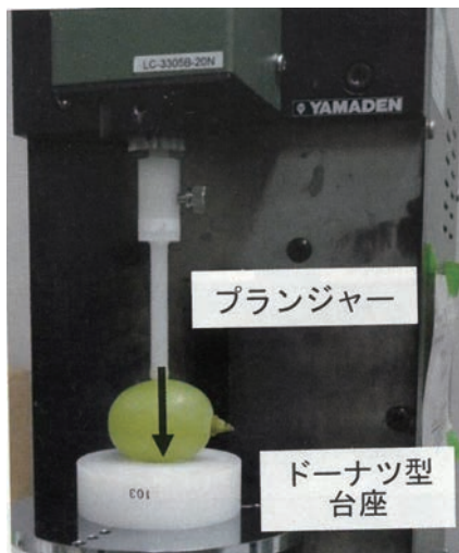
図-1 クリープメーターによる‘シャインマスカット’果粒の物性測定の様子（笈田 2018）
