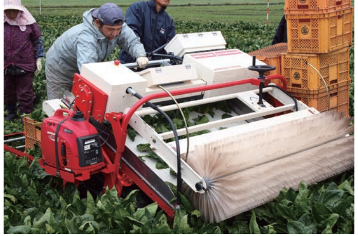
図-3 歩行型ハウレンソウ収穫機(加工用野菜収穫機 NMSH-1300(株)ニシザワ)
