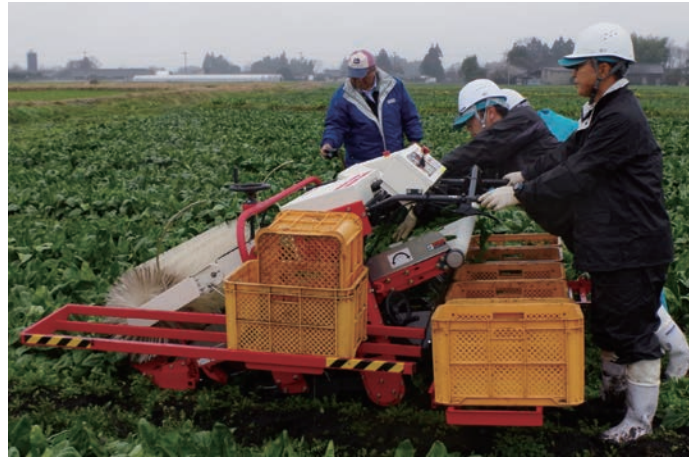
図-6 小型コンテナ横流れ方式での収穫作業
