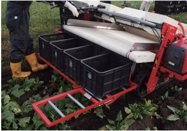
図-5 歩行型ホウレンソウ収穫機の小型コンテナ横流れユニット
