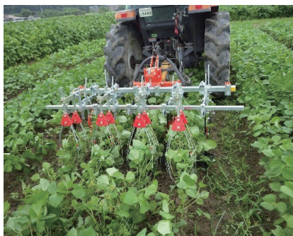
図-4 トラクタに除草カルチを装着し走行している様子
