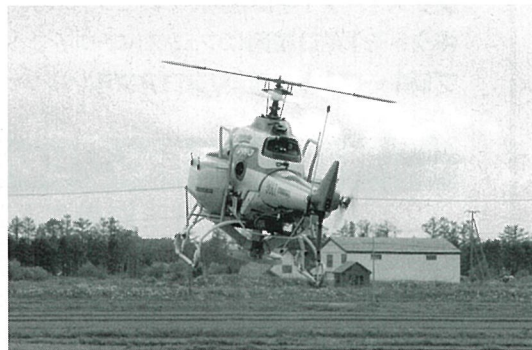
図-2 ラジコンヘリコプターによる除草剤散布
