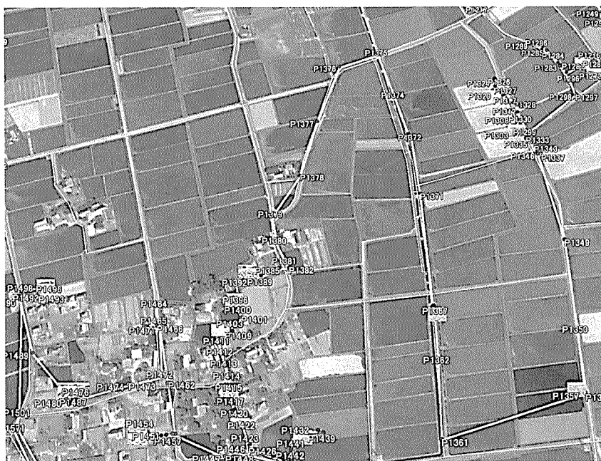
図-4 GPSカメラで撮影した圃場写真のGoogle earthによる表示とGPSのログ GPSカメラの移動ログは約10秒ごとに自動保存され、kml形式で表示
