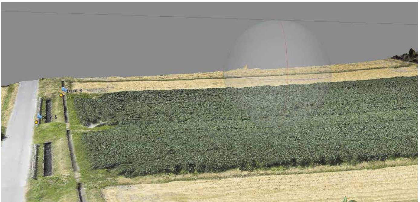
図-7 ドローンの空撮画像から作成した DSM (digital surface model) 画像 写真は大豆圃場を直下視した画像に三次元情報を与えて自動合成したもの(渡邊ら 2015)。
