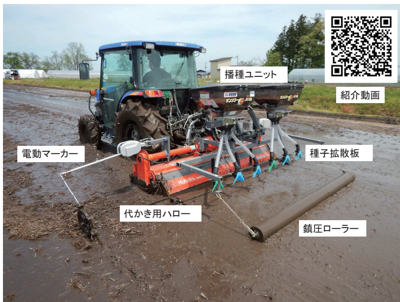
図-2 代かき同時浅層土中播種機と紹介動画 QR コード (白土 2017 を改変)
