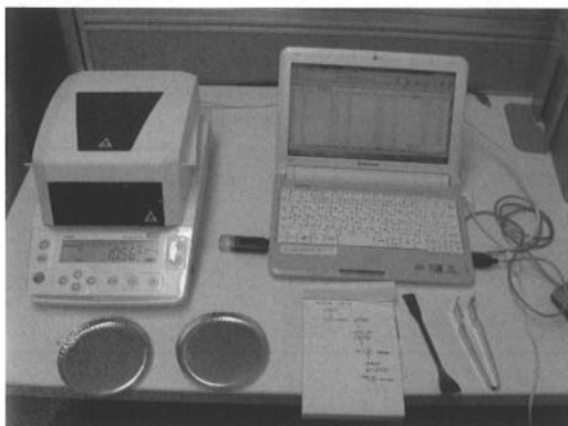
写真-1 ハロゲン型水分計による精製の水分測定。
